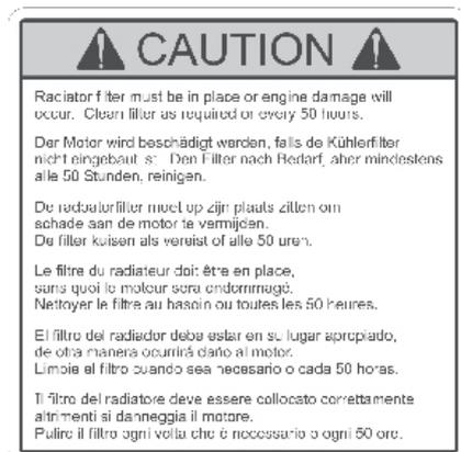
**ВНИМАНИЕ!** Отсутствие фильтра радиатора может стать причиной повреждения двигателя. Чистку фильтра следует проводить каждые 50 часов работы или при его загрязнении.
